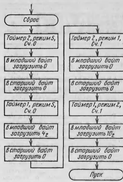
Рис. 6. Алгоритм загрузки управляющих слов и информации в таймер 1 и таймер 2 для получения T_{\text{прог}}=10 мкс и \tau_{\text{прог}}=4 мкс
