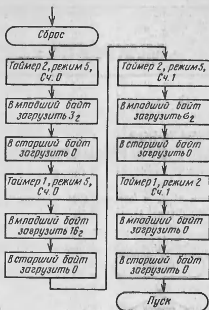
Рис. 5. Алгоритм загрузки управляющих слов и информации в таймер 1 и таймер 2 для получения T_{\text{прог}}=32,6 мкс и \tau_{\text{прог}}=16,3 мкс
