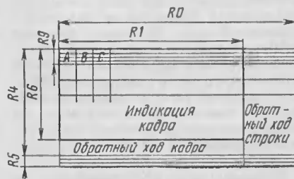
Рис. 3. Формат развертки по кадру
